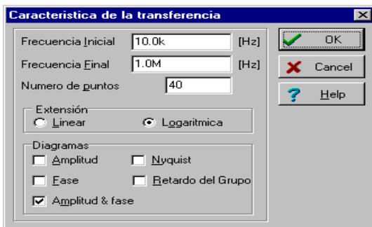
Modificar la frecuencia Inicial para 10k y luego presionar **OK**. Una barra de progreso aparecerá mientras el programa trabaja. Después de haber finalizado el calculo, la característica de amplitud de Bode aparecerá en la ventana del Diagrama. Ud. puede fácilmente conmutar la Fase, los diagramas de Nyquist o el Grupo de retardo usando los botones de los Tabuladores de la ventana del Diagrama.
