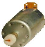
El motor eléctrico acepta tanto corriente directa como alterna y girará más rápido o lento en dependencia del voltaje aplicado. Cuando el motor sea alimentado con corriente directa la dirección de rotación dependerá de la polaridad del voltaje.
