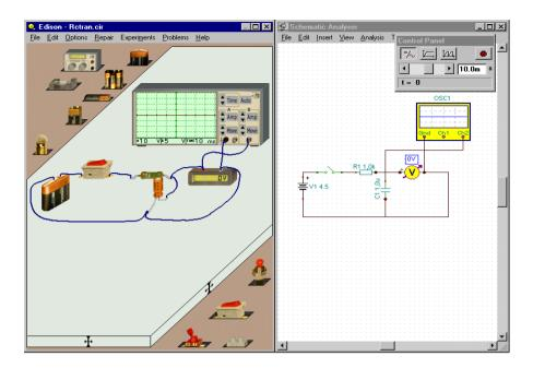
Pour voir d'autres composants pointez n'importe où sur le côté supérieur gauche gris de l'étagère contenant la pile. Une nouvelle étagère apparaîtra avec la résistance et le condensateur dont nous avons besoin.
