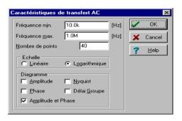
Modifiez la fréquence de départ en 10 k puis pressez sur **OK**. Une barre de progression apparaît pendant que le logiciel calcule. Après la fin du calcul, la caractéristique d'amplitude de Bode apparaît dans la fenêtre de diagramme. Vous pouvez aisément visualiser les diagrammes de Phase, de Nyquist et de Délai de groupe en utilisant les onglets à la base de la fenêtre de diagramme.
