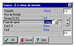
Laissez inchangés les paramètres **Niveau DC**, **Signal** et **Etat ES**. Notez qu'en acceptant *ENTREE* pour le paramètre **Etat ES** vous avez sélectionné la sortie de ce générateur comme entrée pour le diagramme de Bode.
