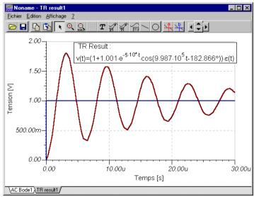
Comme prévu, le circuit RLC montre la réponse de l'oscillation amortie. Les données exactes d'entrée/sortie peuvent être lues en activant les curseurs graphiques **a** et/ou **b**.
