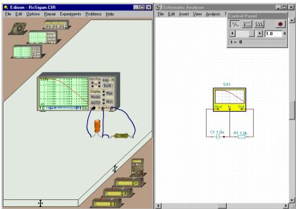
en ?, pressez le bouton droit de la souris. Dans le menu qui apparaît, sélectionnez Diagramme et un diagramme détaillé apparaît dans une nouvelle fenêtre (montrant les mêmes résultats que l'analyseur de signal). Vous pouvez aussi obtenir les formules décrivant le diagramme en sélectionnant Formules dans le menu. Vous pouvez copier-coller les formules soit vers la fenêtre de diagramme, soit vers celle du schéma.
